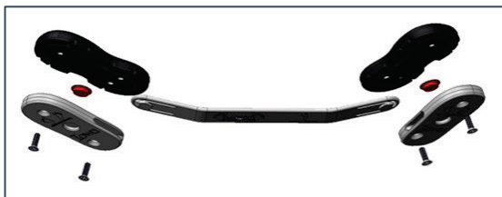
Преглед склапања делова Iowa Brace шине
